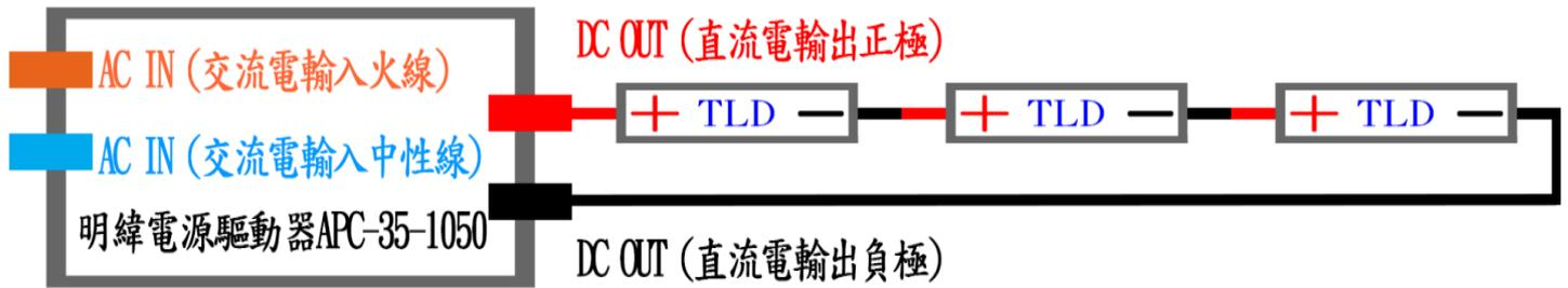
例二：十支輕鋼架龍骨燈搭配明緯電源驅動器
